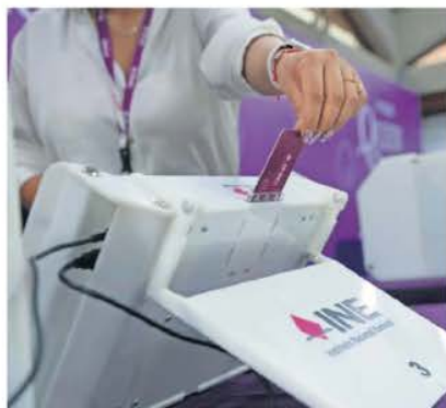
Los ciudadanos introducirán a la urna electrónica una tarjeta de votación, una vez colocada, en la pantalla irán apareciendo cada una de las boletas.
